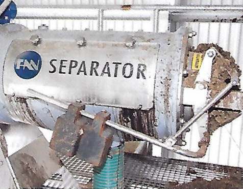
Separator służy do oddzielania z gnojowicy frakcji stałej od płynnej.
